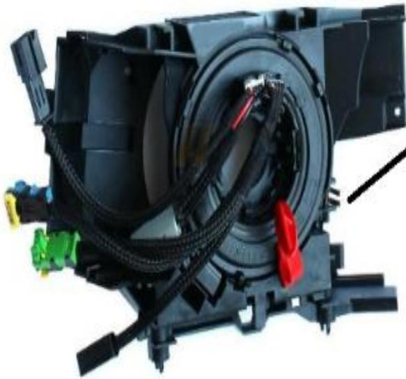
*Conector Clavija Claxon. Este conector debe estirar hacia fuera para que llegue corriente eléctrica correcta al conector a la hora de montaje.*
